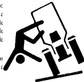
O cinto de segurança deve ser usado durante o funcionamento da máquina quando a máquina estiver equipada com um ROPS certificado.
